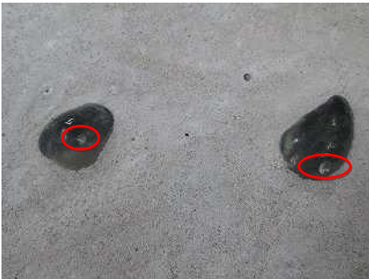
写真② 実験 Part.1 欠けたような傷が生じる
