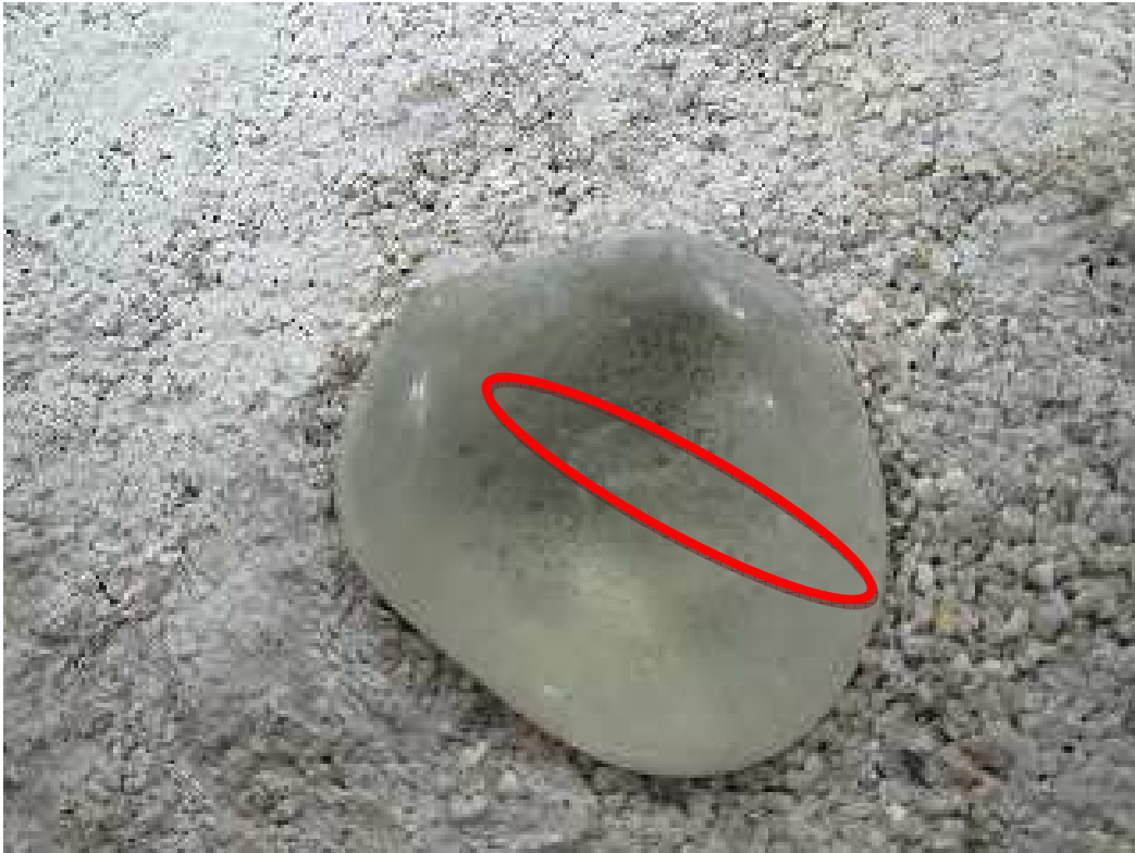
写真③ 実験 Part.2 ストーンの中に亀裂のような筋
